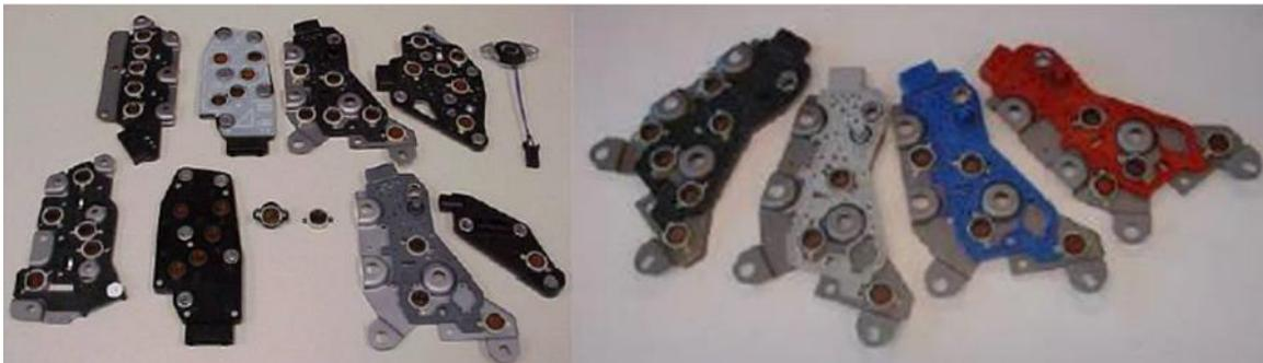
Figura 2.2: Diferentes modelos de PSM
