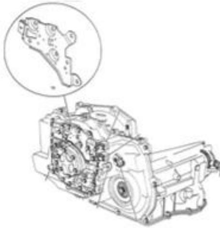
Figura 2.1: Localización de un PSM en la transmisión
